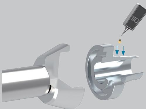
**3.4** Inserire il tubo attraverso l'apertura della piastra dell'apparecchio di premontaggio e premere il cono flangiatore contro il piattello di pressione. Quindi calzare sul tubo il morsetto. Spostare il morsetto sul tubo e posizionarlo nell'apertura conica della piastra dell'apparecchio.
