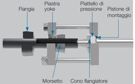
**3.5** L'avvio della procedura di montaggio deve essere eseguito secondo quanto riportato nelle Istruzioni per l'uso dell'apparecchio di premontaggio. Mediante la corsa del pistone il cono flangiatore viene introdotto del tubo fino a quando resta uno spazio residuo compreso tra 1 e 5 mm di larghezza (vedere Tabella).
