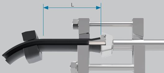
**2.4** Preparazione dell'estremità del tubo: Segare il tubo ad angolo retto. È consentita una tolleranza angolare di  $\pm 1^\circ$ .
