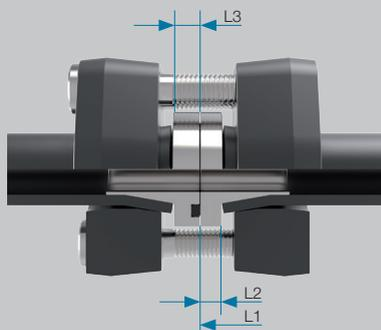
**2.3** Rispetto della lunghezza diritta del tubo: Per il montaggio dei coni flangiatori ZAKO è necessario considerare, per le tubazioni curvate, una lunghezza minima dell'estremità diritta del tubo. Osservare le indicazioni qui riportate nelle rispettive Istruzioni per l'uso della macchina/apparecchio di premontaggio.
